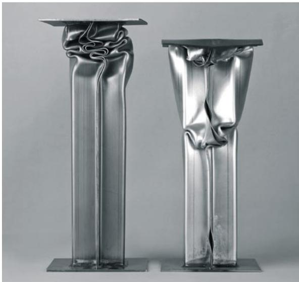
*Bei gleicher Bauteilgeometrie und Wandstärke zeigt der HSD®-Stahl (links) im Vergleich zu einem heute gebräuchlichen höchstfesten Dualphasenstahl (rechts) eine deutlich höhere Energieaufnahme bei gleicher crashartiger Beanspruchung. Das erlaubt dem Konstrukteur einen größeren Gestaltungsspielraum bei der Auslegung der einzelnen Komponenten.*
