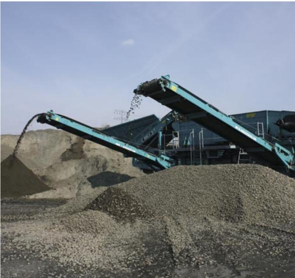
*Vor der Aufbereitung wird der ausgebaute Schotter nach Größe sortiert.*
