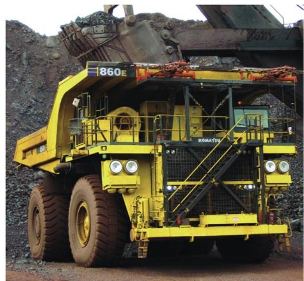
Trucks wie der 860E-1K von Komatsu können Nutzlasten von 260 Tonnen und mehr befördern. Antriebssysteme von Siemens sorgen dafür, dass die Produktivität im Bergbau gesteigert und Umweltbelastungen gesenkt werden können.
