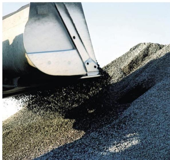
Hochofenschlacke: Wertstoff für den Straßenbau, Rohstoff für die Zementindustrie.
