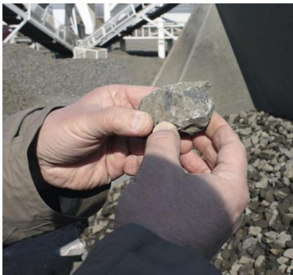
*Nur kantige Steine mit einem Durchmesser von 32 bis 63 Millimetern können wieder verwendet werden.*
