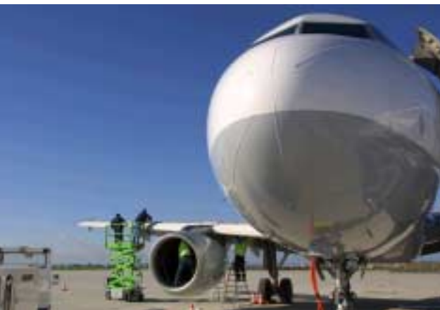
Links: Lärmtechnisch modifizierte Lufthansa A319 während der Lärmesskampagne 2001 am Flughafen Cochstedt: Mitarbeiter von Lufthansa Technik bereiten das Flugzeug auf die Messflüge vor.
